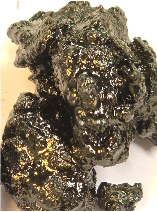
Nedan – ABS-massa med en "överdos" av cellulosafibrer (0,4%)
