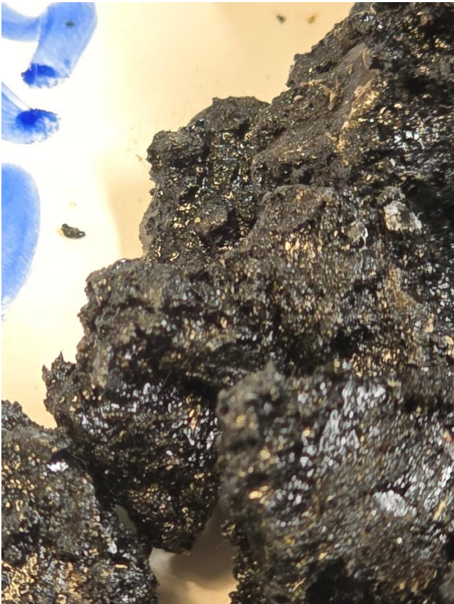
Nedan – ABS-massa med en "överdos" av cellulosafibrer (0,4%)
